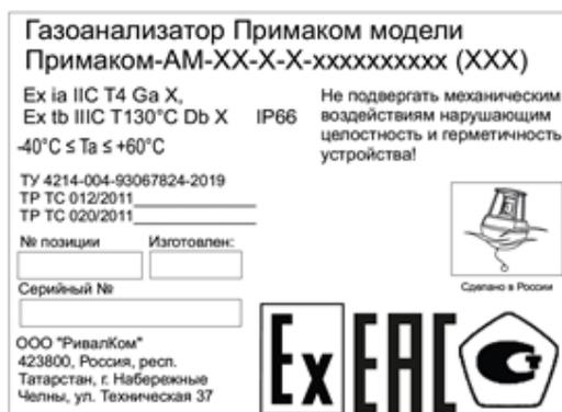
Рисунок 12 – Общий вид идентификационной таблички и место нанесения знака утверждения типа для газоанализаторов Примаком модели Примаком-АМ
