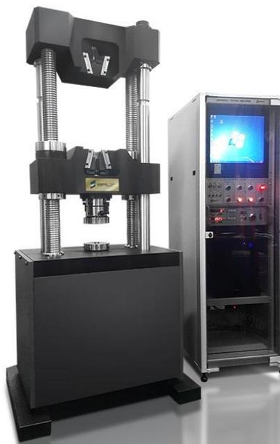
Рисунок 1 – Общий вид машин испытательных универсальных ST-1004
