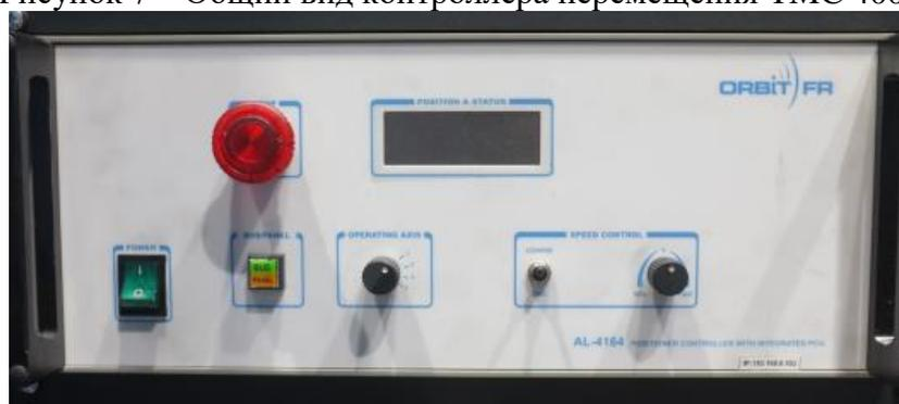
Рисунок 8 – Общий вид контроллера движения AL-4164-4MC-BL
