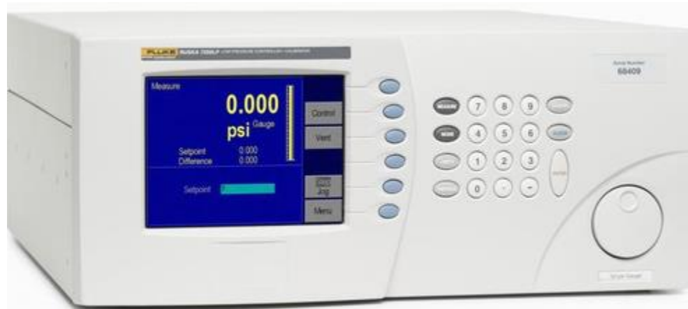
Рисунок 1 – Общий вид калибратора давления Ruska 7250LP
