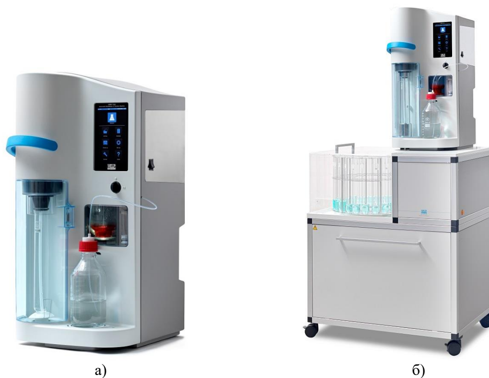
Рисунок 1 - Общий вид анализаторов азота UDK 159 (а) и UDK 169 с системой AutoKjel (б)
