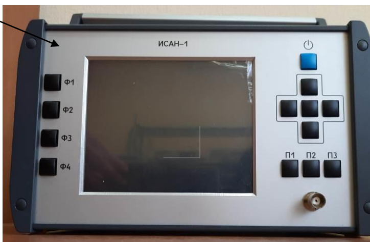
Рисунок 3 — Вид лицевой панели измерителя
