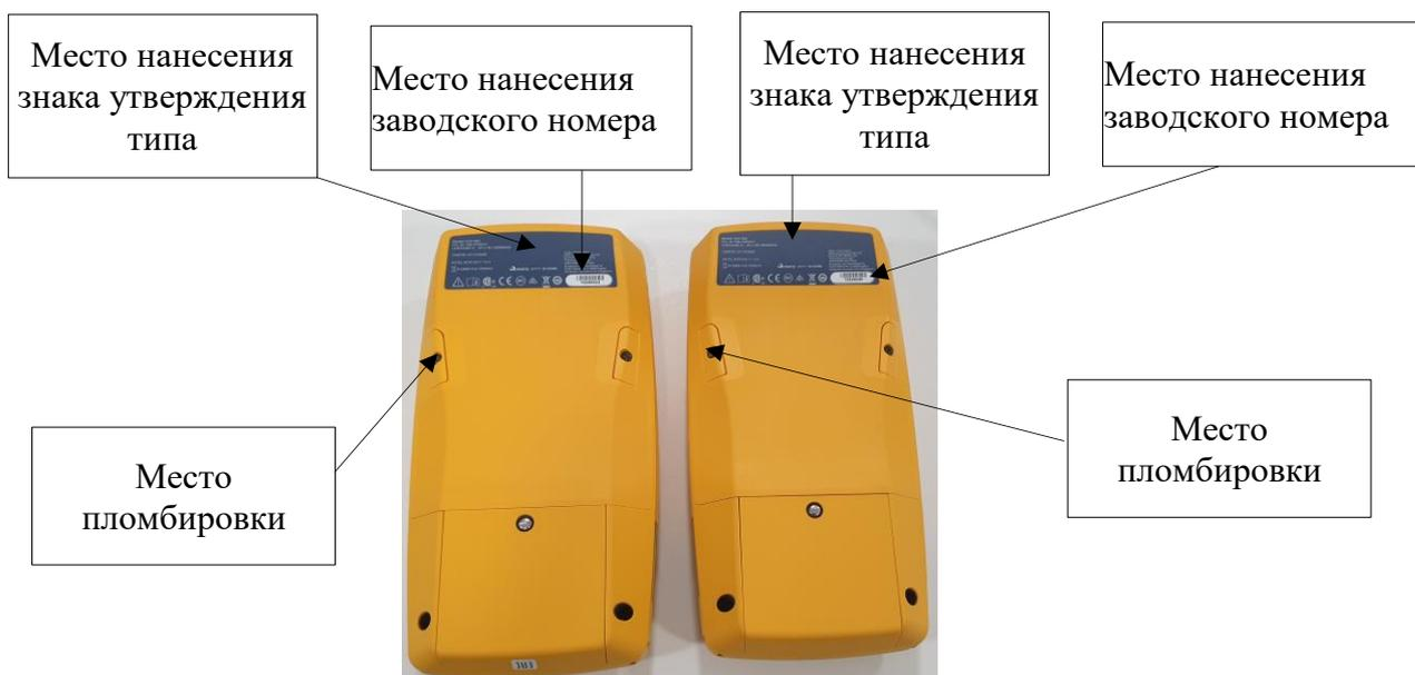
а) устройство Remote б) устройство Main
