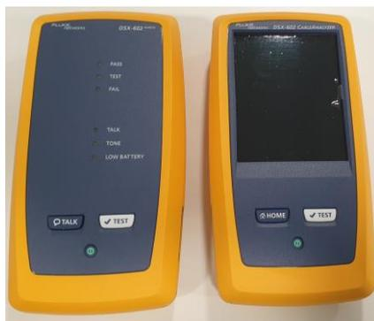
а) устройство Remote б) устройство Main
