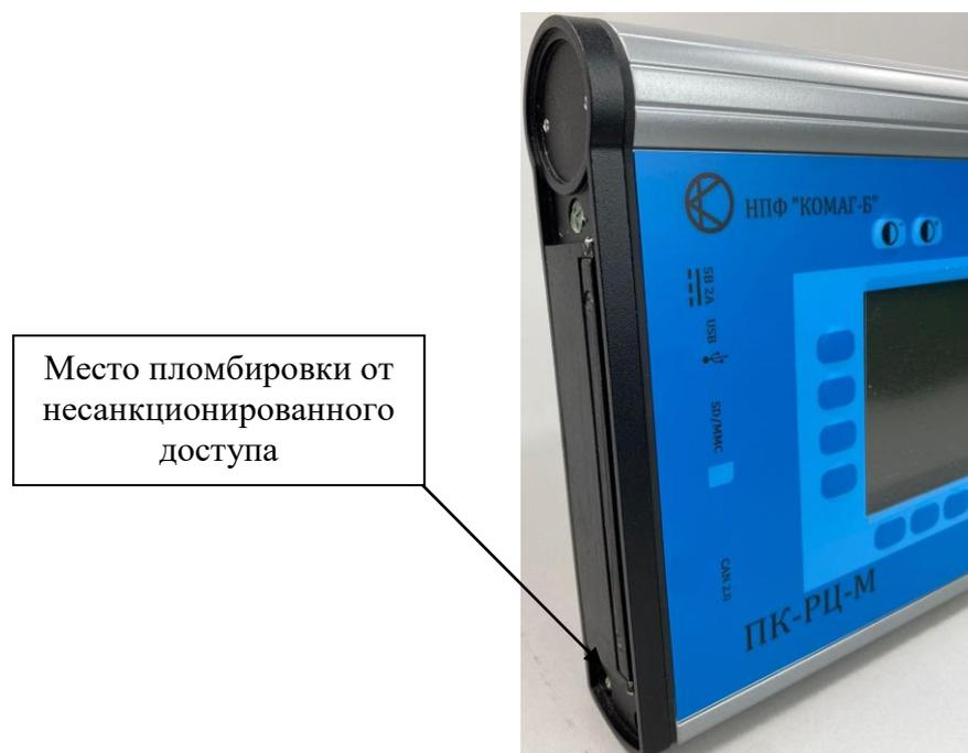
Рисунок 3 – Место пломбировки от несанкционированного доступа
