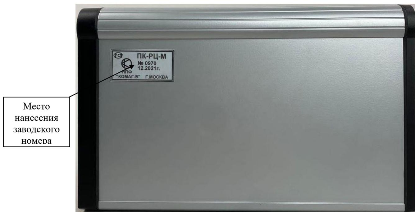
Рисунок 2 – Общий вид приборов комбинированных для измерения сигналов рельсовых цепей многофункциональных ПК-РЦ-М. Вид сзади
