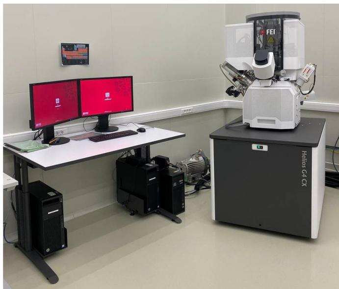
Рисунок 1 – внешний вид системы микроскопической инспекции FEI Helios G4 CX
