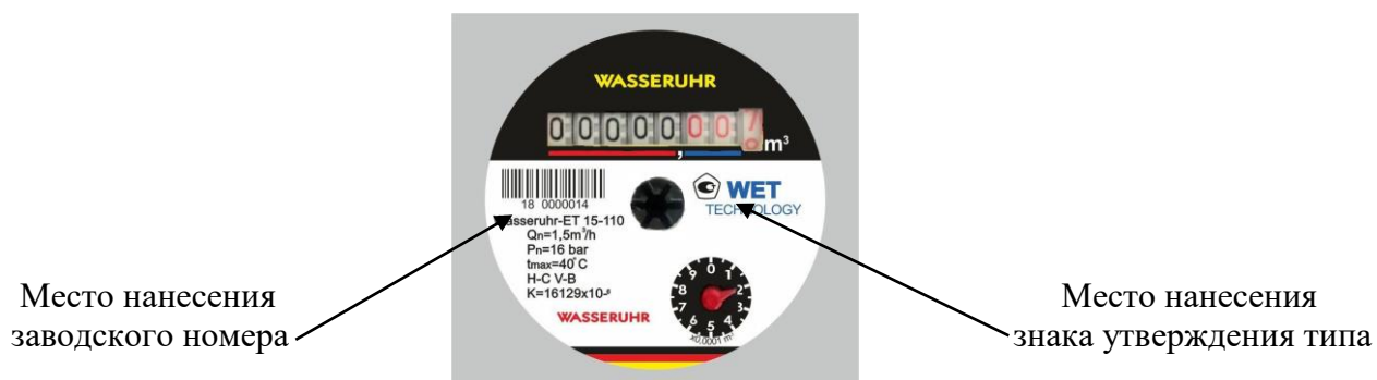
Рисунок 3 – Место нанесения знака утверждения типа и заводского номера
