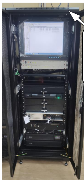
а) Устройство приемно-измерительное сигналов ГНСС
