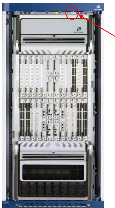
Рисунок 2 - Внешний вид оборудования с открытой дверью. Выделено место нанесения серийного номера
