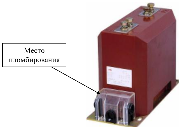
Рисунок 1 – Трансформатор тока ТПУ 73.41 и обозначение места пломбировки от несанкционированного доступа
