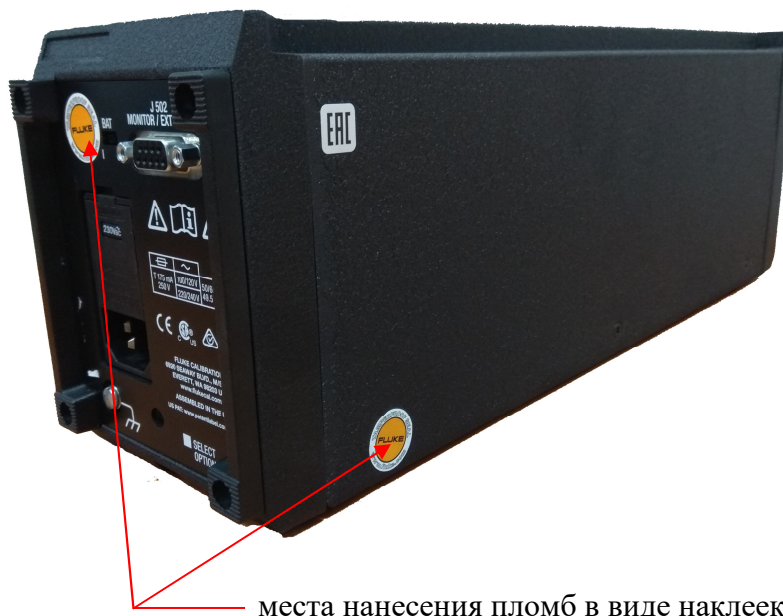
Рисунок 2 - Схема пломбировки от несанкционированного доступа
