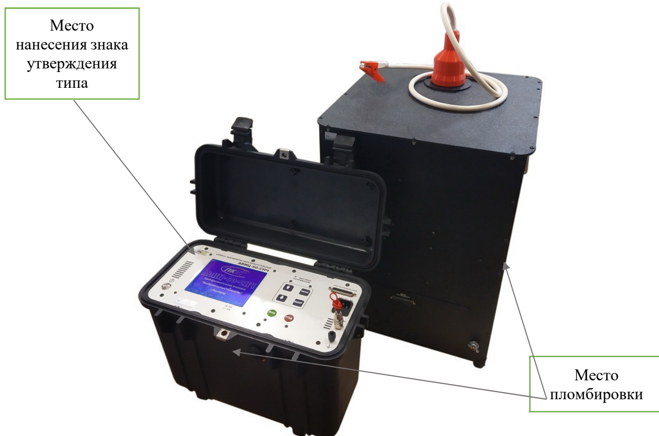
Рисунок 1 - Общий вид средства измерений и обозначение мест пломбировки от несанкционированного доступа
