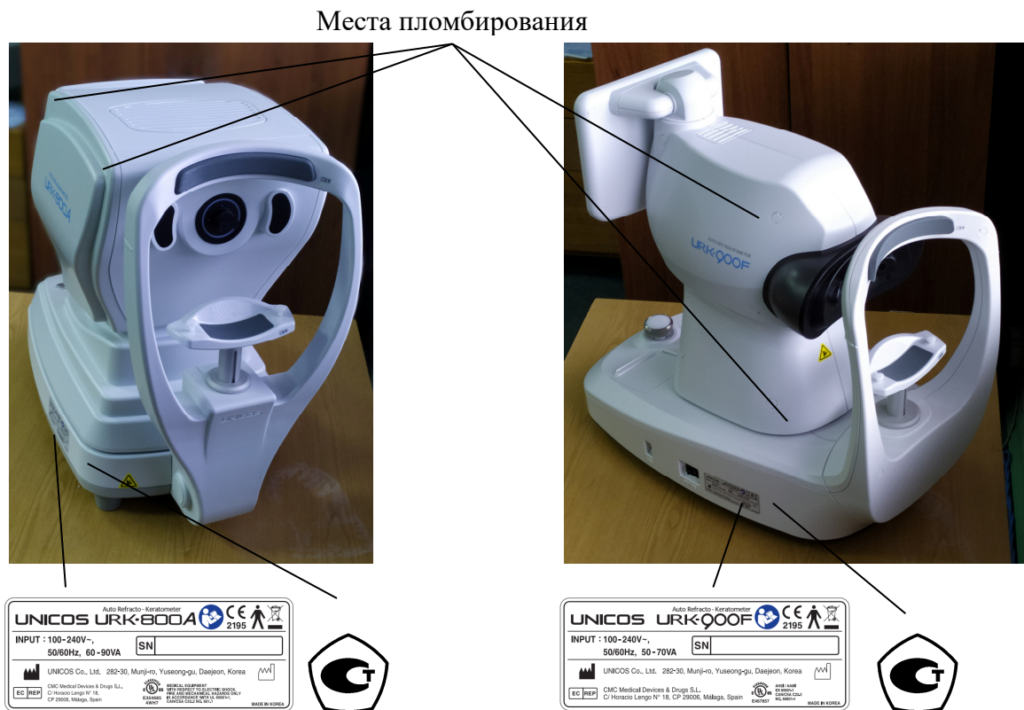
Рисунок 2 – Общий вид, схема маркировки и схема пломбирования от несанкционированного доступа авторефрактометров: а) модель URK-800A б) модель URK-900F
