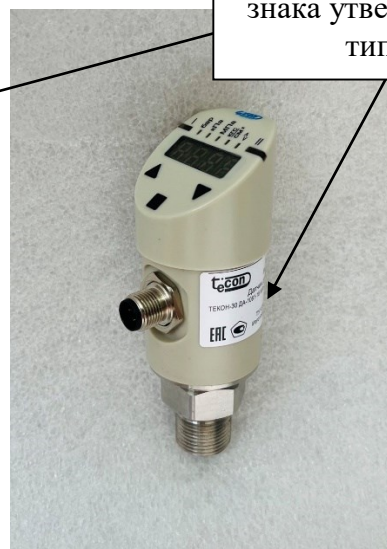
Рисунок 2 - Общий вид датчиков штуцерного конструктивного исполнения, место нанесения заводского номера и знака утверждения типа
