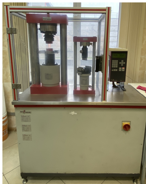
Рисунок 1 – Общий вид машины испытательной на сжатие и изгиб TONIPRAX
