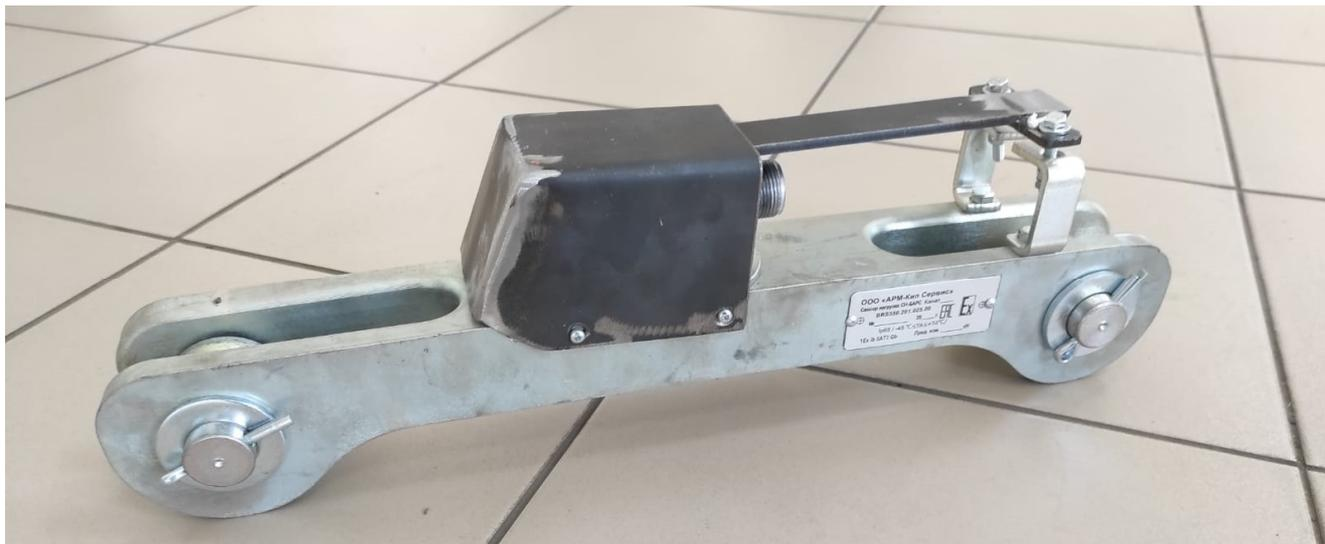
Рисунок 1 – Общий вид сенсора нагрузки СН-БАРС.
