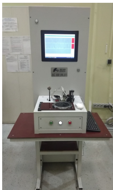
Рисунок 1 – Общий вид приборов вихретокового контроля приставных бортиков ВГ НК-УК.01
