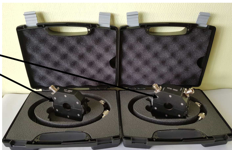
Рисунок 2 – Общий вид токоъемников НТ-1000, НТИ-1000, обозначение места пломбировки
