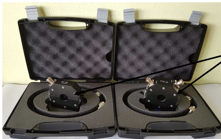
Рисунок 1 – Общий вид токоъемников НТ-20, НТИ-20, обозначение места пломбировки
