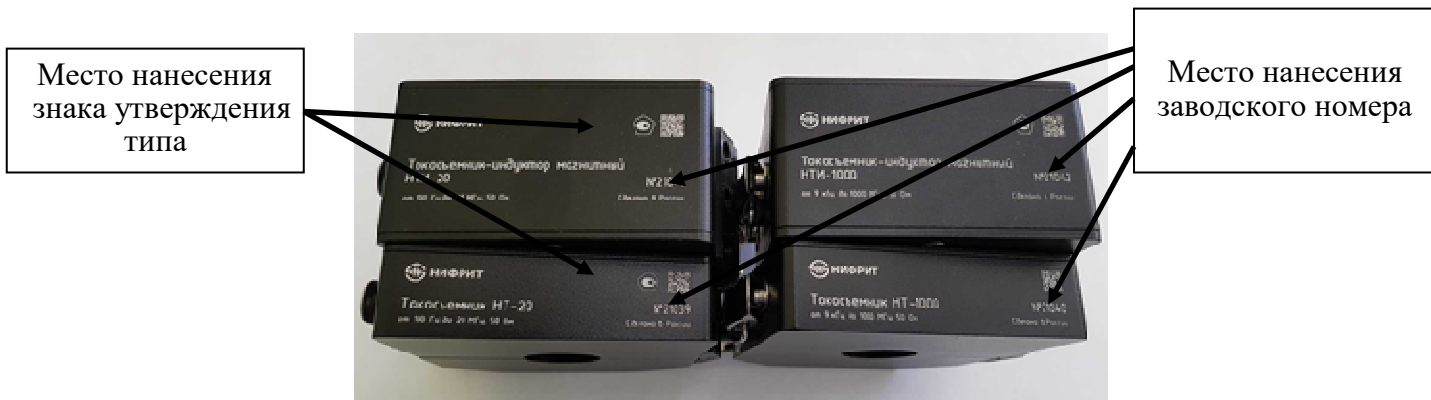
Рисунок 3 – Место нанесения знака утверждения типа, обозначение места нанесения заводского номера
