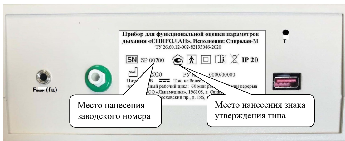
Рисунок 2 – Место, способ и формат нанесения заводских номеров или буквенно-цифровых обозначений, однозначно идентифицирующих каждый экземпляр средств измерений и знака утверждения типа
