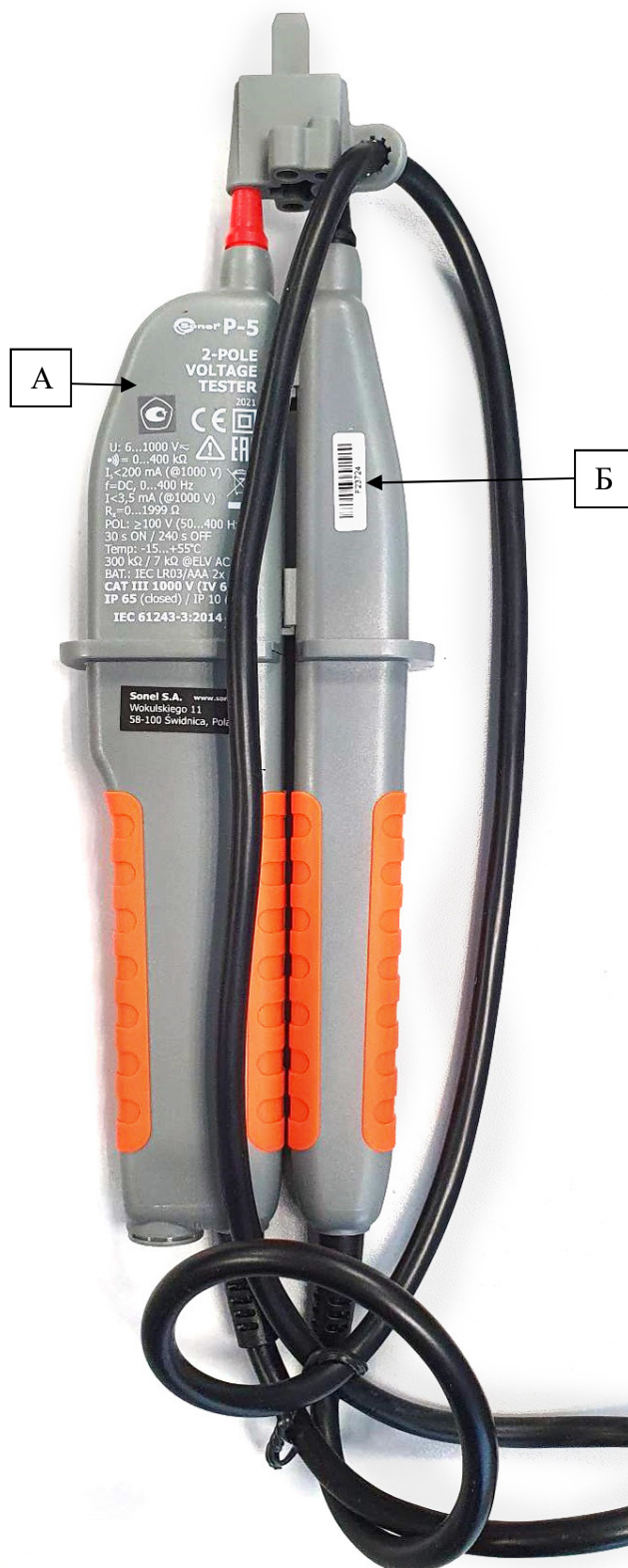
Рисунок 2 – Места расположения знака утверждения типа (А) и заводского номера (Б) на измерителях напряжения Р модификаций Р-5, Р-6
