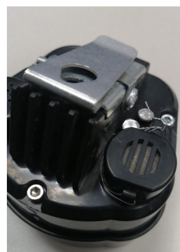
Рисунок 5 – места пломбировок головной фары
