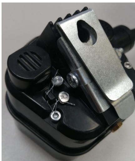
Рисунок 5 – места пломбировок головной фары
