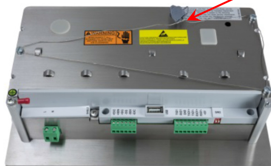
Рисунок 2 – Общий вид и схема пломбировки терминала IND570 от несанкционированного доступа
