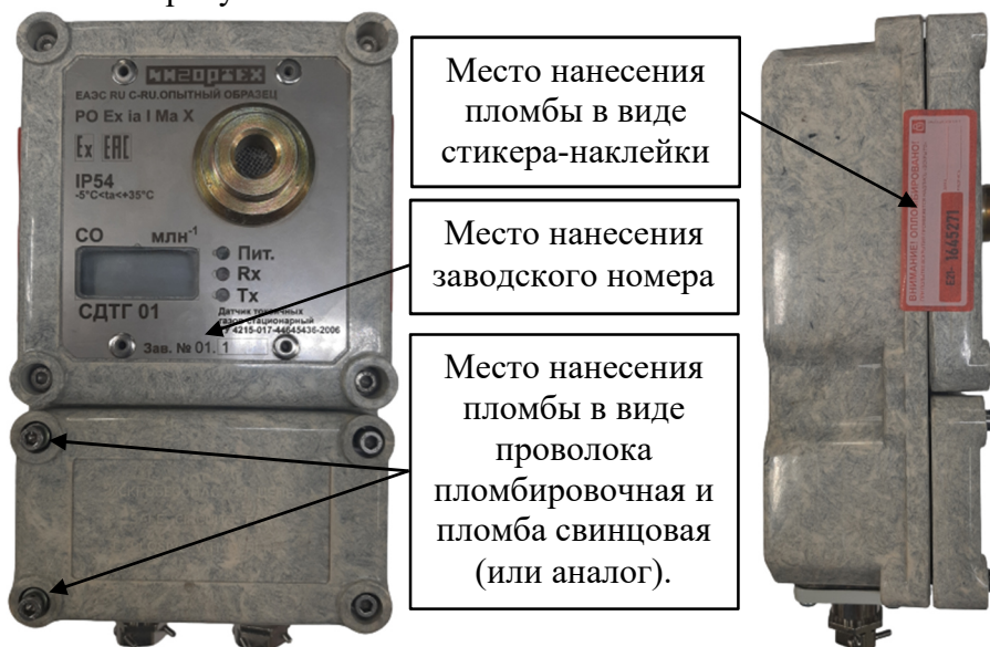
а) чувствительный элемент встроен в крышку аппаратного отделения
