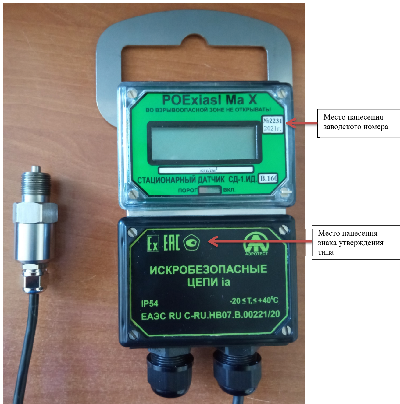
Рисунок 1 – Датчик измерения давления СД-1.ИД.В. Место нанесения заводского номера и года изготовления, знак утверждения типа.
