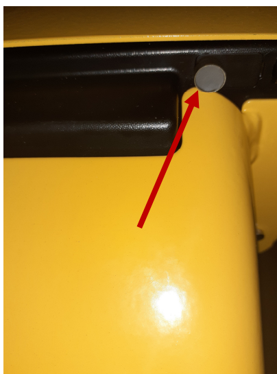
Рисунок 4 - Схема пломбировки от несанкционированного доступа и обозначение места для нанесения знака поверки в виде оттиска на мастичной пломбе
