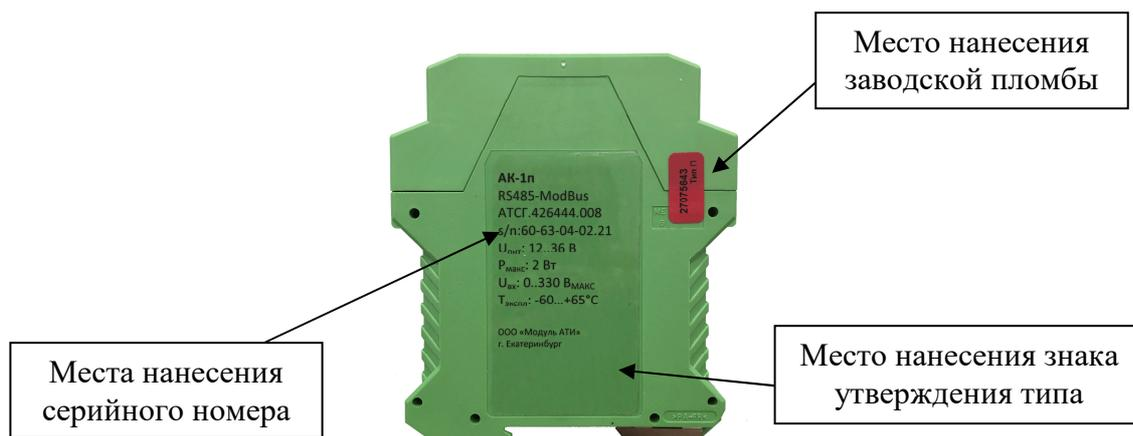
Рисунок 1 – Общий вид АК-1п и места пломбировки
