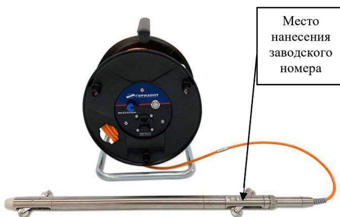
Рисунок 3 – Общий вид инклинометров
