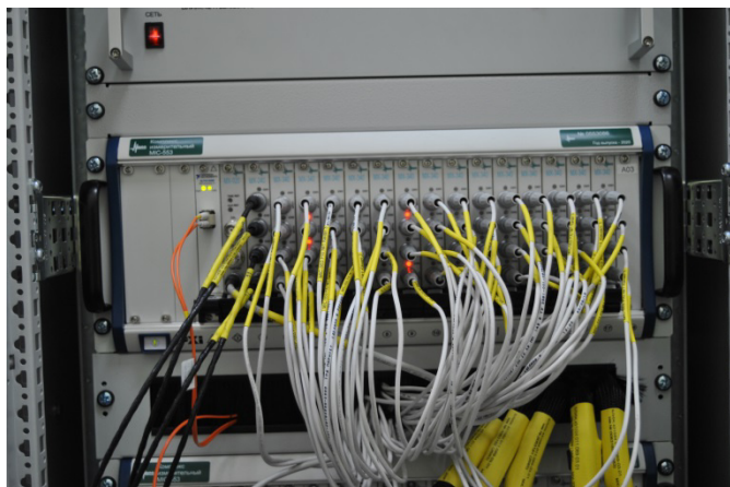
Рисунок 3 – MIC-553 PXI №1 в стойке
