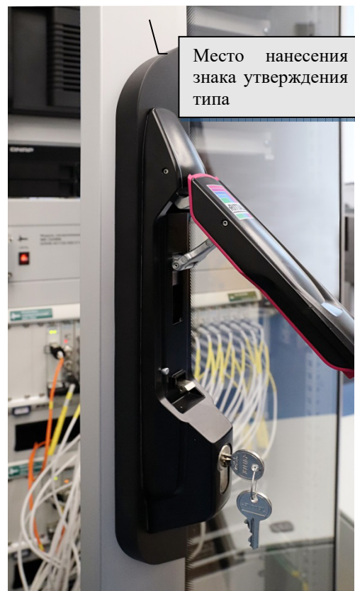
Рисунок 2 – Запирающий механизм стойки.
