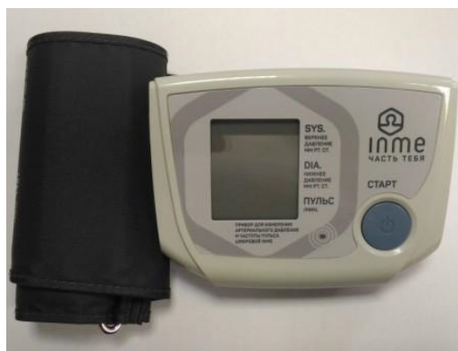
Рисунок 1 – Общий вид прибора для измерения артериального давления и частоты пульса цифрового INME модель INME-01
