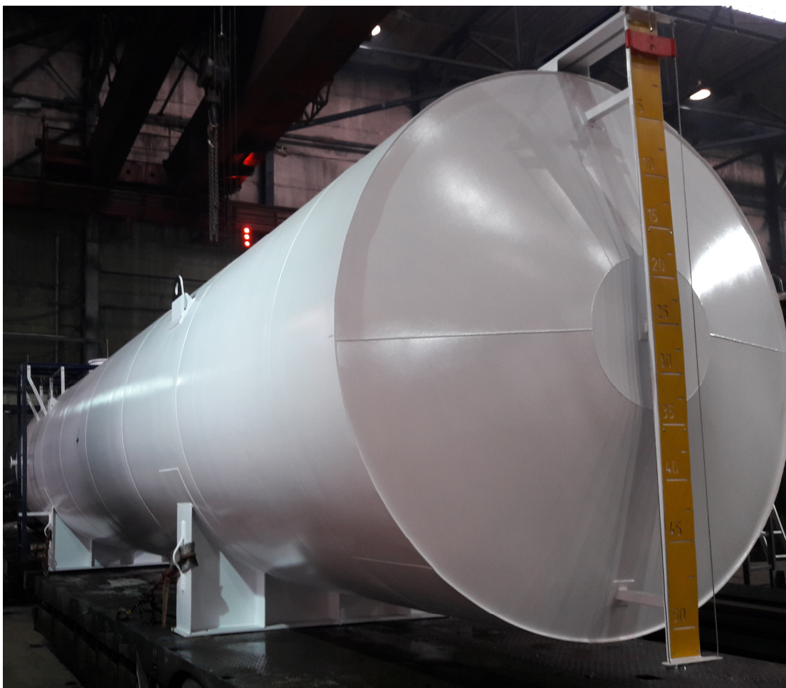
Рисунок 3 – Общий вид резервуаров РСн-50 Пломбирование резервуаров РСн-50 не предусмотрено.
