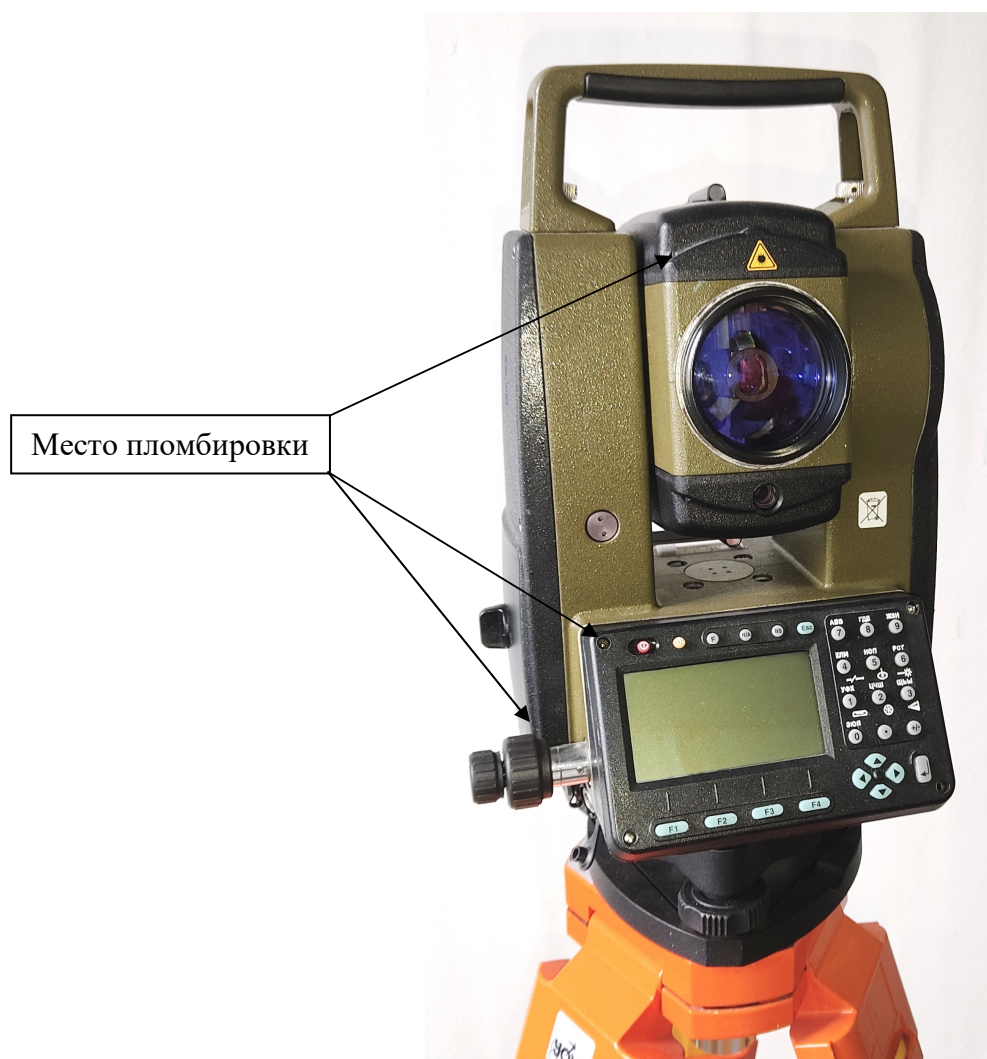
Рисунок 2 – Общий вид тахеометров. Места пломбировки от несанкционированного доступа
