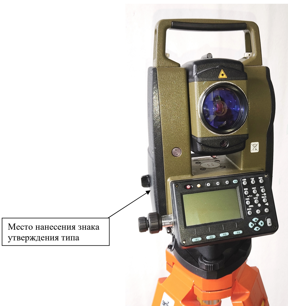
Рисунок 1 - Общий вид тахеометров. Место нанесения знака утверждения типа
