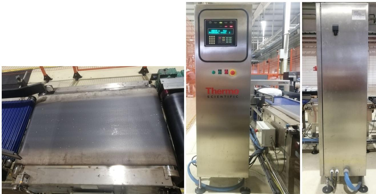
Рисунок 1 – Общий вид весов (весового модуля и шкафа управления)
