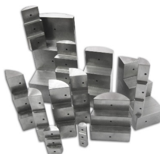
Рисунок 9 – Форма мер «Цилиндр» с сегментными углами
