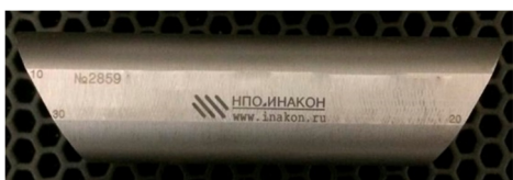
Рисунок 8 – Форма меры «Цилиндр» с углами скоса
