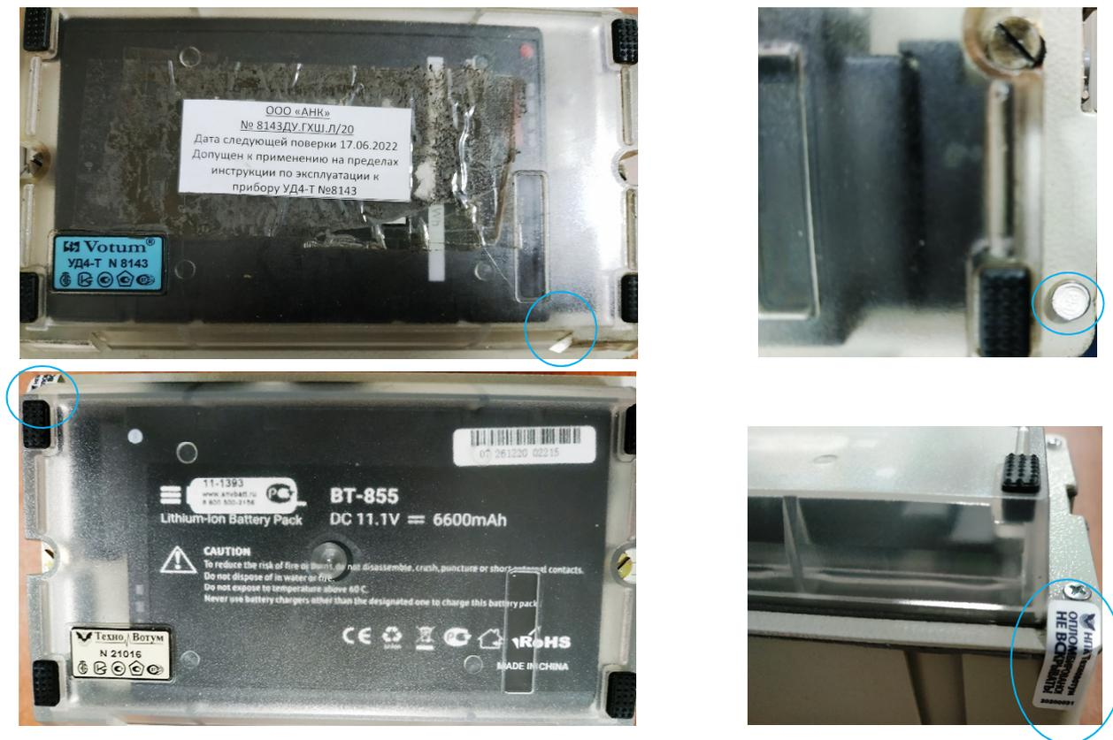
Рисунок 4 – Схема пломбировки от несанкционированного доступа
