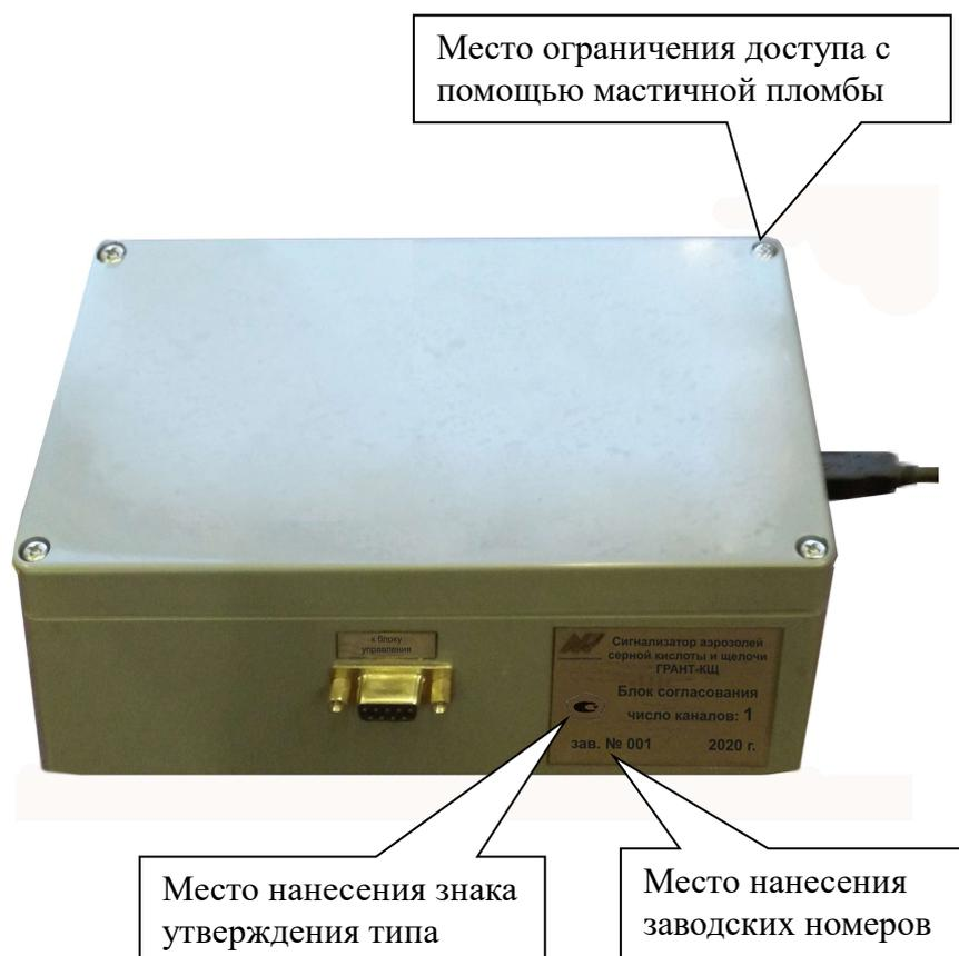
Рисунок 4 – Общий вид блока согласования
