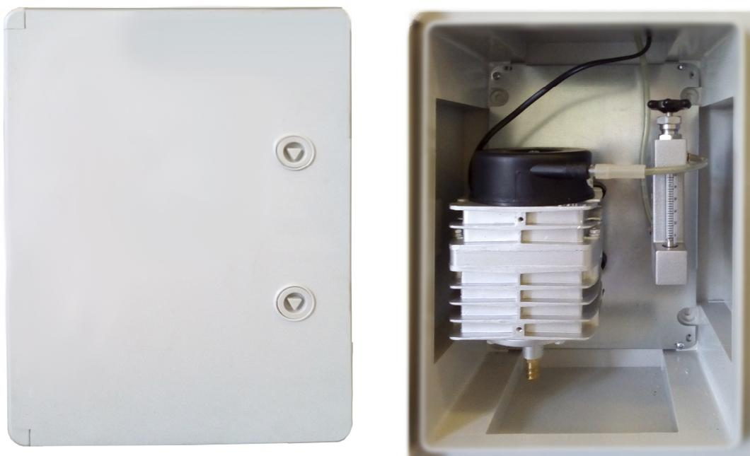
Рисунок 3 – Общий вид блока пневматического
