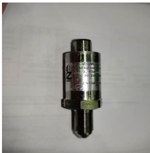
Рисунок 8 – Преобразователь давления измерительный ADZ-SML-20.4 (верхний предел измерений 250 кг/см 2 ). Вид общий
