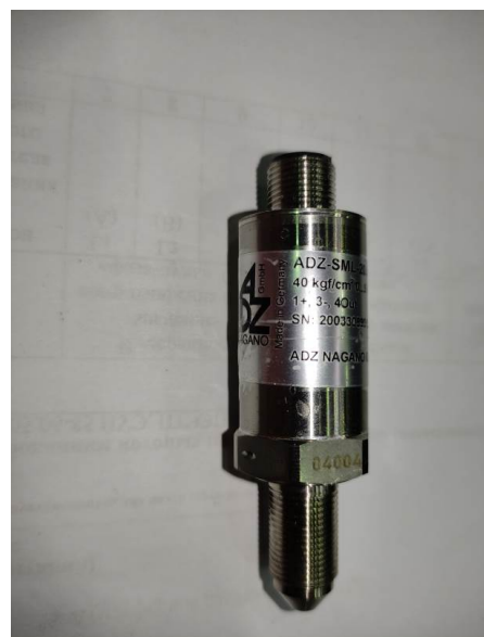
Рисунок 7 – Преобразователь давления измерительный ADZ-SML-20.4 (верхний предел измерений 40 кг/см 2 ). Вид общий
