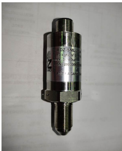
Рисунок 6 – Преобразователь давления измерительный ADZ-SML-20.4 (верхний предел измерений 10 кг/см 2 ). Вид общий
