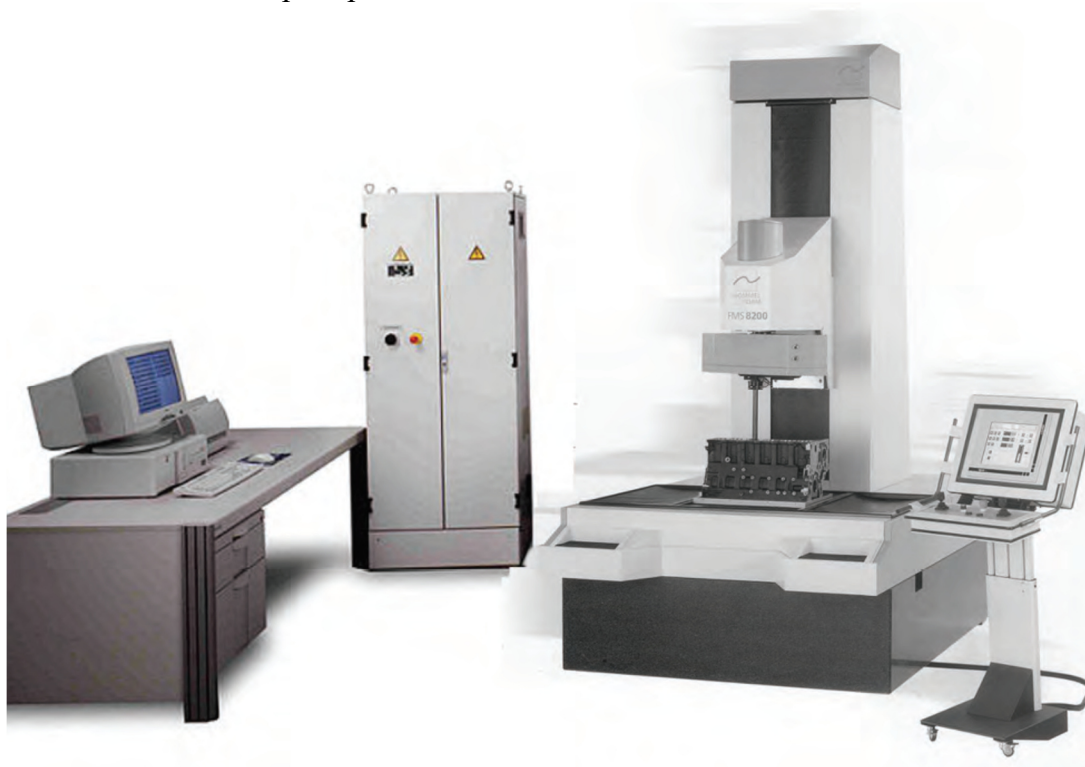
Рисунок 1 – Общий вид прибора для измерений отклонений формы и расположения поверхностей вращения FMS 8200
