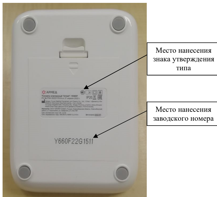
Рисунок 22 – Схема нанесения маркировки для исполнений YE660B, YE660E, YE660F, YE900, YE690A, YE690B, YE690D, YE670A, YE670D, YE650A, YE650D, YE666D, YE655B, YE655D, YE680A, YE680B, YE630AR, YE630A
