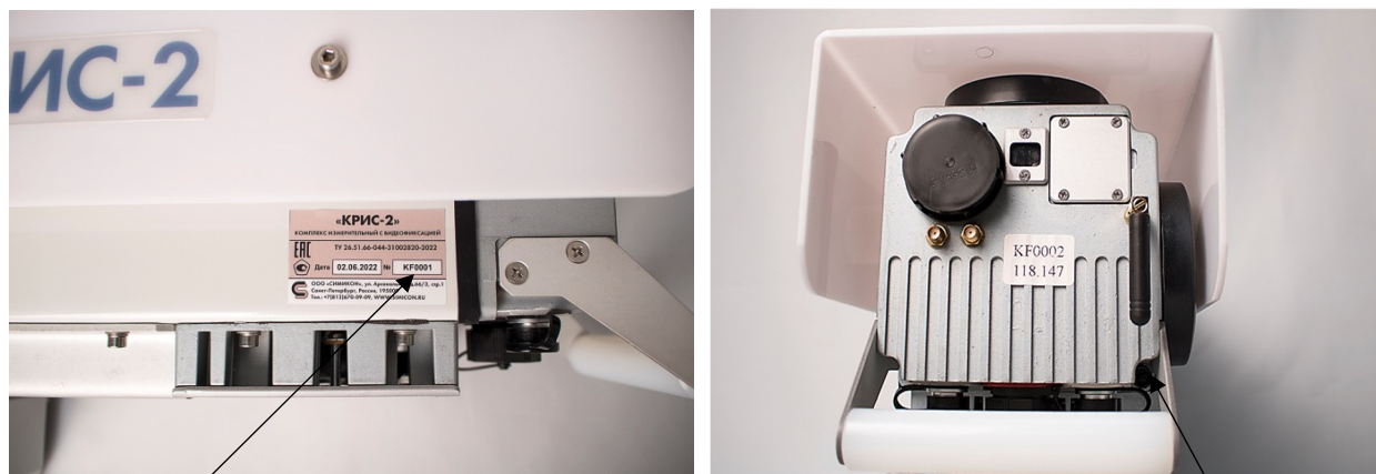
а) Место нанесения знака утверждения типа и заводского номера б) Место пломбировки от несанкционированного доступа.
