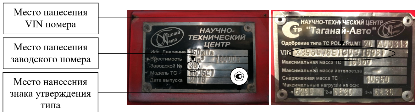
Рисунок 2 – Маркировочные таблички топливозаправщика с указанием мест нанесения заводского номера, VIN номера и знака утверждения
