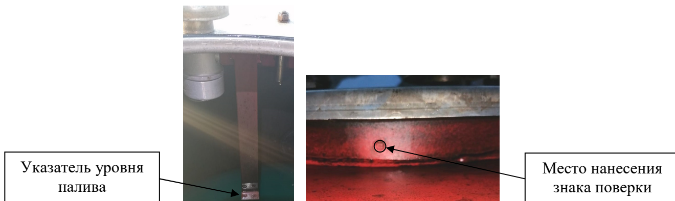
Рисунок 3 – Общий вид указателя уровня налива с указанием места нанесения знака поверки
