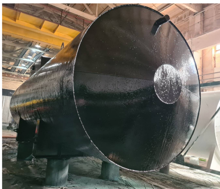
Рисунок 3 – Общий вид резервуара РГСПД-25-2760 № 603 с указанием места нанесения заводского номера
