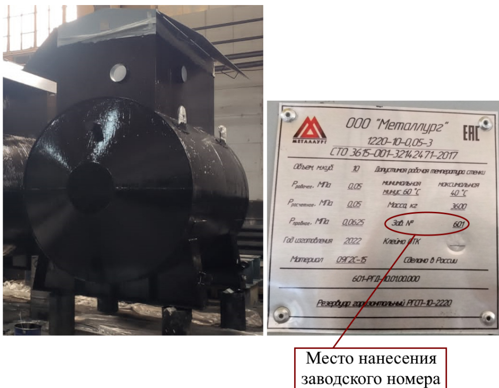
Рисунок 1 – Общий вид резервуара РГСП-10-2220 №601 с указанием места нанесения заводского номера
