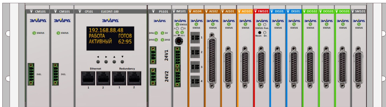
Рисунок 1 – Общий вид контроллера Elicont-100 с модулями в металлическом корпусе Пломбирование не предусмотрено.
