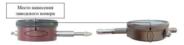
Рисунок 2 – Место нанесения заводского номера
