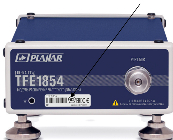
Рисунок 2 – Общий вид модуля и место нанесения знака утверждения типа
