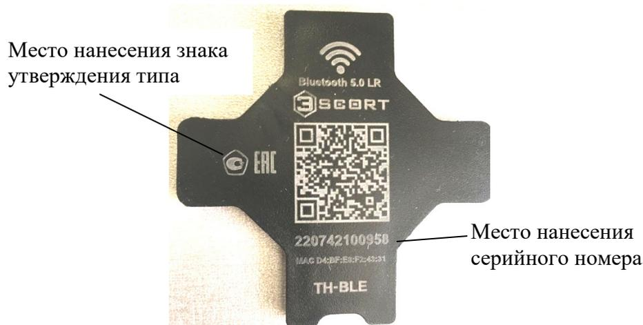
Рисунок 3 – Маркировочная крышка с указанием мест нанесения знака утверждения типа и серийного номера
