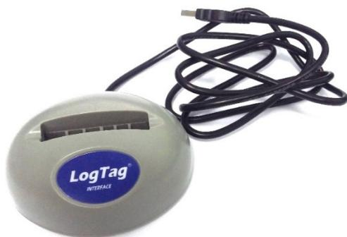
Рисунок 16 – Общий вид интерфейса связи LogTag LTI/USB
